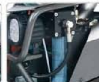
Standaard met vetpomp en automatisch smeersysteem voor de gereedschappen.
