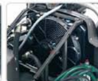
Automatische elektrische ventilator voor extra doeltreffend koelen.
